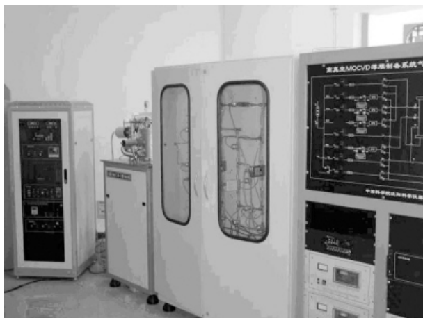
与中科院沈阳科仪中心共同研发的生长 ZnO 薄膜的 MOCVD 设备
